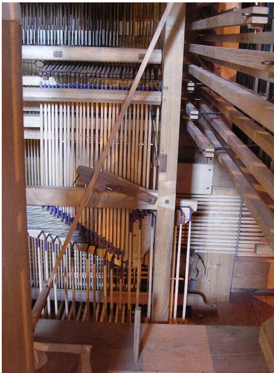
Interno dell'Organo: la trasmissione meccanica , i meccanismi di unione pedali-tastiere e di azionamento dei registri.
