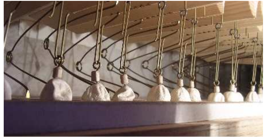
Ventilabris : valvole azionate tramite meccanica dalle dita dell'organista e richiamate da molle in ottone
