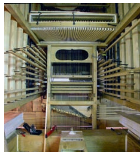
Het Écho is direct achter de klaviatuur in de bovenste onderkast geplaatst; onder is de pedaaltractuur zichtbaar; links en rechts de registermechaniek van het Grand Orgue (11 juli 2008).
